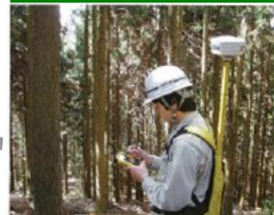
衛星を利用した測量、及び編集ソフトを使用した出力を行い、省労力・少人数での現場測量・製図が可能になります。
